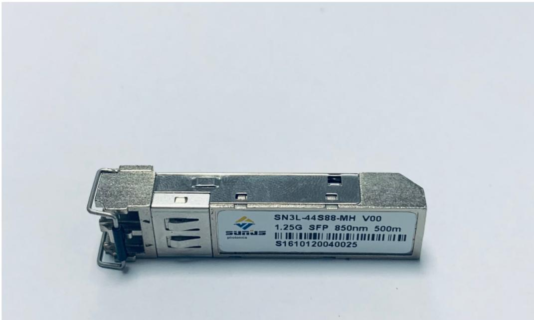
普通光模块的芯片TO-CAN能承受的温度范围在0~70℃；工业级光模块的TO-CAN能承受的温度范围在-40~85℃。普通光模块，进行常温老化，高温较多只能承受70度，理想的工作温度是0~70℃。工业级光模块：需要进行高低温老化测试，温度较高能承受85度，在低于0℃的环境，模块都能稳定地工作。大家都知道光模块是影响整个网络性能的关键因素，特别是在工业以太网中，网络连接控制的多为大型工业设备，光模块的稳定性尤为重要。那么，我们该如何选购工业级光模块呢？接下来就由小编来为大家详细介绍下该如何选购工业级光模块，一起来看看吧：看光模块的温度适应能力，温度适应能力是工业光模块较重要的评判标准，周围环境相对于工业光模块来说不管是高出还是低于其工作温度范围，都会对它的光功率、光灵敏度等重要参数产生影响，因此看清光模块的温度适应能力尤为重要。SONET/SDH光模块生产商家高契合度的工业级光模块设备也是当下像技术应用发展得到更好的实用状态的关键。
